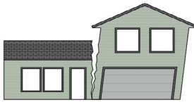
Rupture pendant un tremblement de terre
