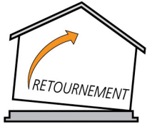
Manifestation des forces d'un séisme sur une maison
